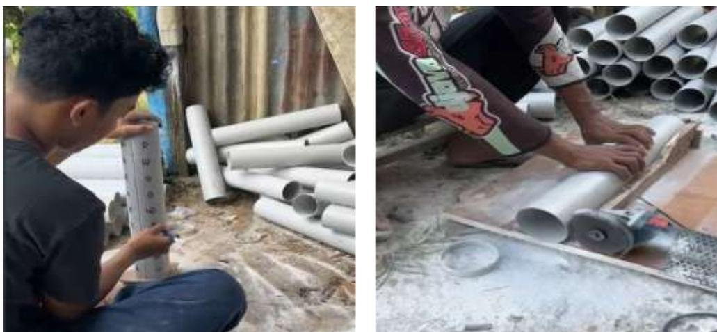
**Gambar 1:** proses pemotongan dan pelubangan paralon
