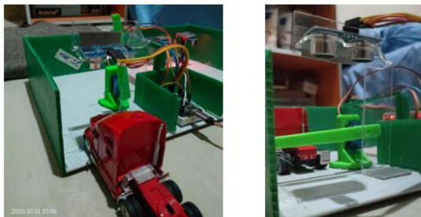
Gambar 8 Kendali Motor Servo pada Respon Sensor Ultrasonik
