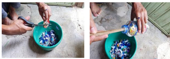
Gambar 1 Proses pembuatan ecobrick
