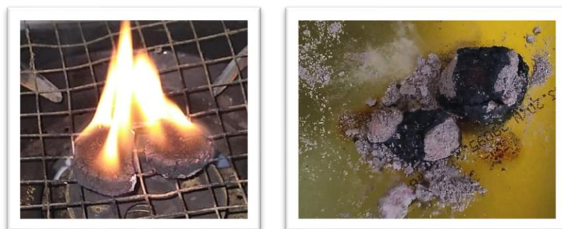
Gambar 3. Hasil Uji Pembakaran Briket Ampas Teh
