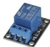
Gambar 2.5 Bentuk Rele Satu Channel
